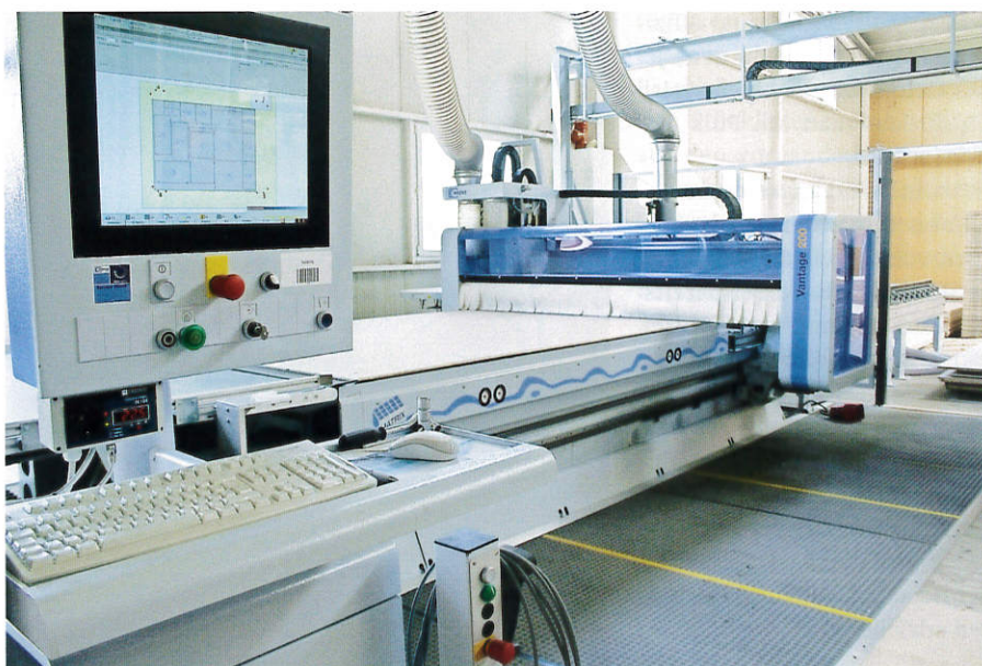
Die Weeke Vantage 200-Nestingzelle ist der jüngste Maschinen-Neuzugang und ein wichtiger Bestandteil der Fertigungslinie.
